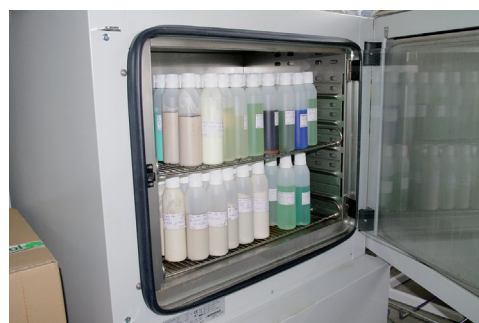
Климатичен шкаф за изпитване на стабилността на суспензии и разтвори
